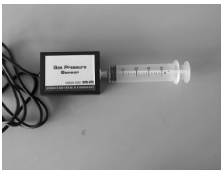
Fig. 1 – La siringa fissata alla sonda di pressione.
